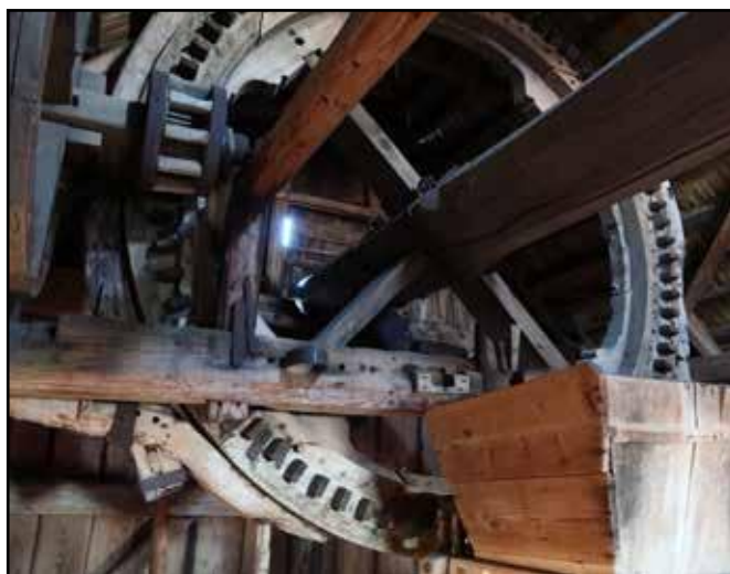
Větrný mlýn Partutovice - 2020 - paleční a cévové kolo (foto autor)
